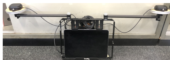
図-3 可視化デバイスと GNSS 受信機
