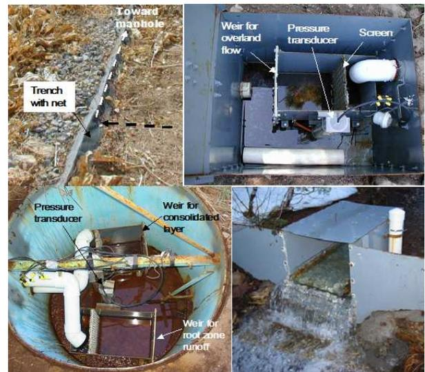
図-4 表面流集水用のトレンチ (左上)、表面流測定用のマンホール内部 (右上)、中間流測定用のマンホール内部 (左下) および河川流量観測用の堰 (右下) の写真 (Oharaら, 2011)
