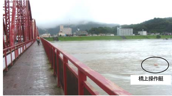
図-5 橋上操作艇による曳航計測状況
