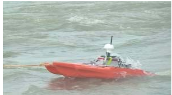
図-2 ADCPを搭載する橋上操作艇の計測状況
