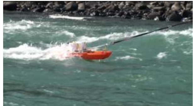
図-17 ボートにADCP、RTK-GPS、MEMS傾斜センサーを搭載して揺動実験を行っている状況
