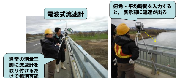
図-13 高度化した観測方法（電波式）
