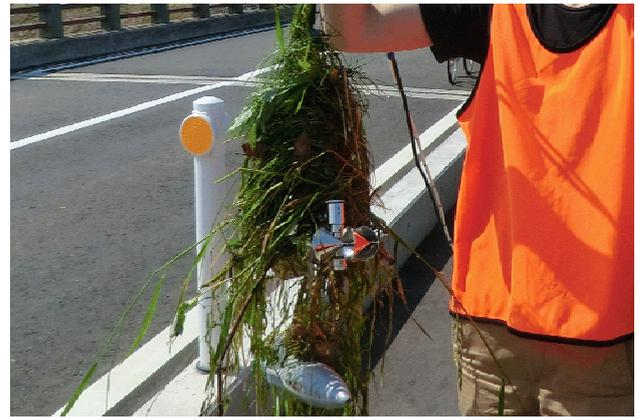
写真-9 プライス式流速計に草木が絡みつく様子。
