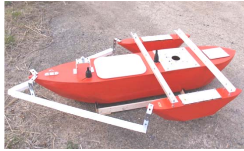
図-12 著者らが作成したトリマラン型橋上操作艇
