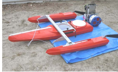
図-13 市販の高流速低揺動型曳航ボート (ハイドロシステム開発社製)
