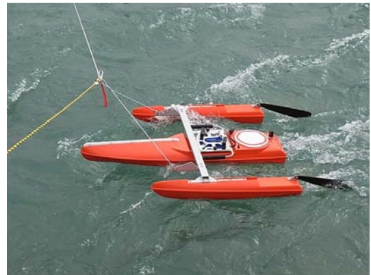
写真-13 ADCPを搭載した高速セーフティサーベイヤー
