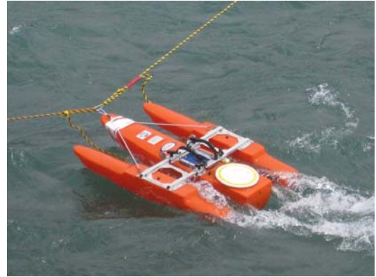
写真-12 ADCPを搭載したリバーボート
