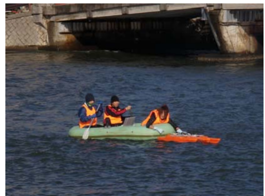
写真-6 ボート曳航式移動流況観測(奈呉ノ浦付近)
