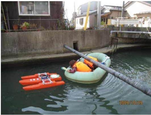
写真-7 障害物を潜りながらのボート曳航式移動流況観測
