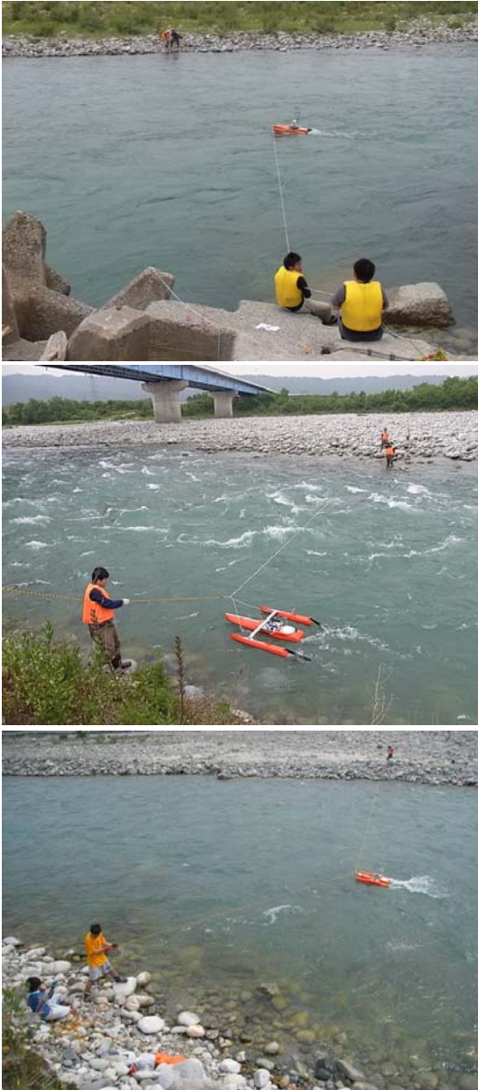
写真-11 各断面における流量観測風景（写真上段：断面①，中絶：断面②，下段：断面③）
