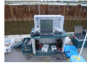
d) ADCP無線通信システム
