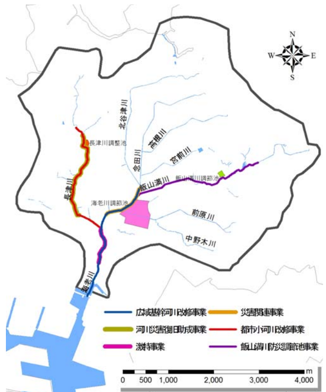
図-5 海老川流域内で実施された治水事業
