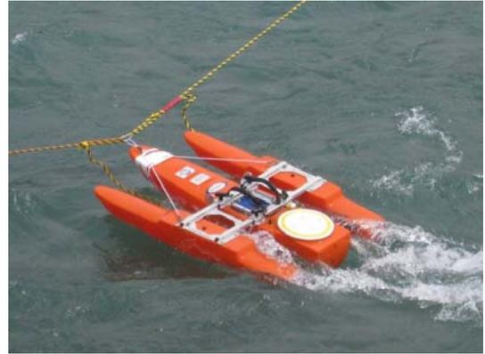
写真-12 ADCPを搭載したリバーボート
