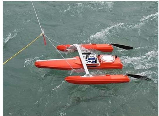
写真-13 ADCPを搭載した高速セーフティサーペイヤー
