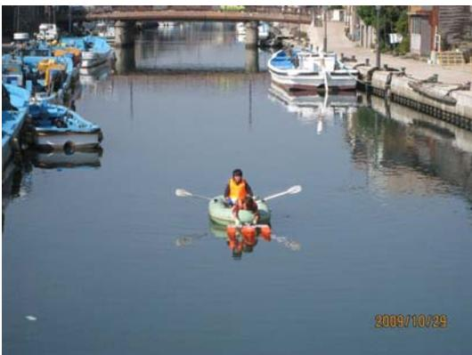
写真-5 ボート曳航式移動流況観測(東内川)
