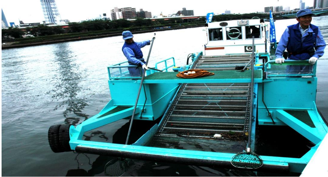
このベルトコンベアー？で水面のゴミを巻上げる
