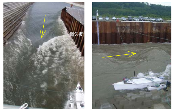
図-8 ADCP計測状況(左:Case7, 右:Case8)
