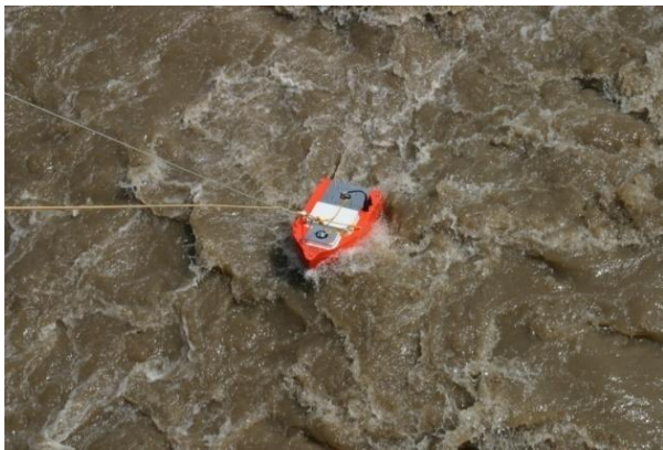
図-10 モノハル型の橋上操作艇（著者らの試作ボート）
