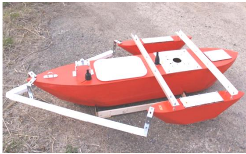
図-3 著者らが作成したトリマラン型橋上操作艇 15)
