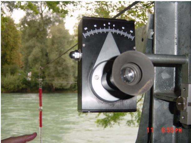
図－5 流速計吊り下げ装置の傾きを測定する
