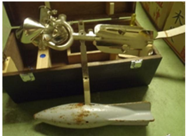
写真-2 本研究に使用したプライス式流速計.
