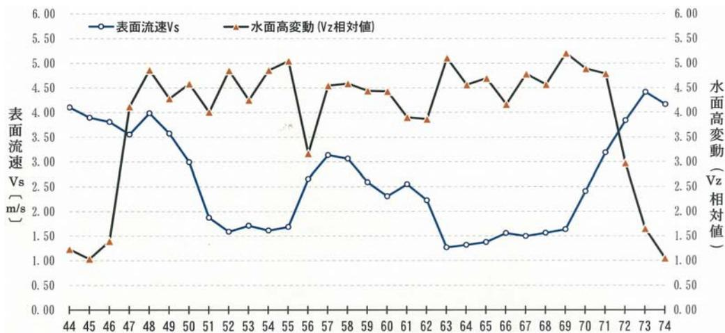
図-3 鉛直方向流速+表面流速, 横断分布図
