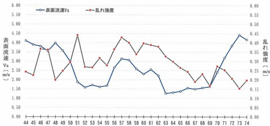
図-1 表面流速横断分布 (橋下流12m, 計測時間1分)
