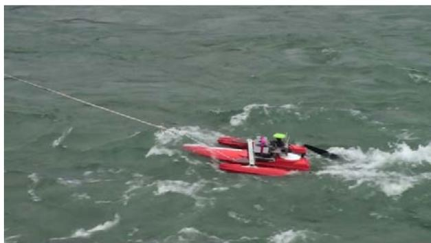
図-5 ADCP 及び周辺機器を搭載した橋上操作艇
