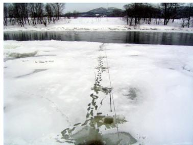
図-2 河川結氷直後の流量観測測線(天塩川恩根内)
