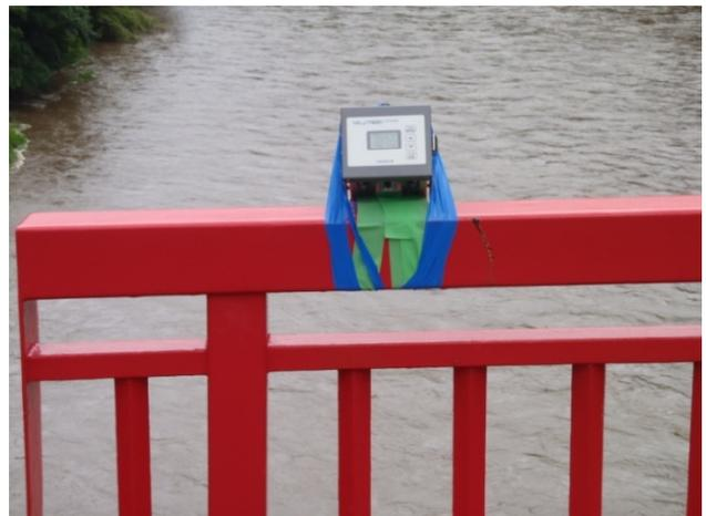
写真-3 欄干に設置した電波流速計の様子.
