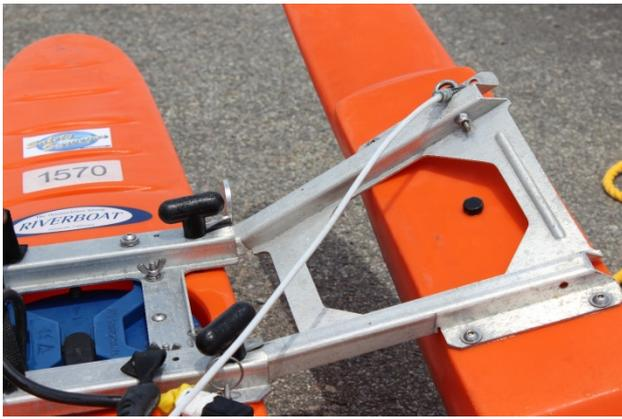
写真-8 亀裂が入りねじ曲がったADCPの様子。
