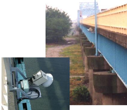
図3. 固定電波流速計設置写真
