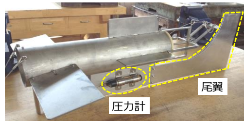
図-9 改良した水中採水器
