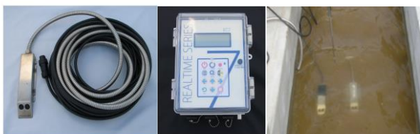
図-1 観測機器及び水路底面への設置事例
