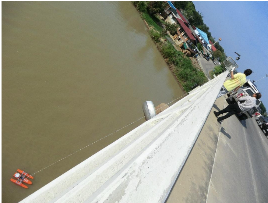
写真-1 C.35観測所下流の橋上でADCPを操作する風景.
