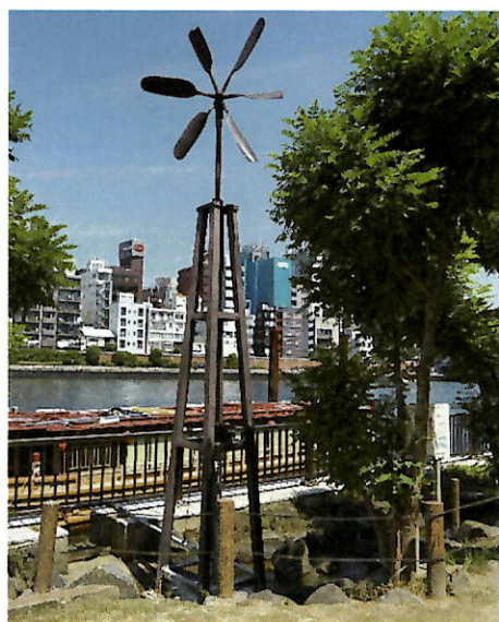
隅田川の水を風車式ポンプで取水し水路に循環させる
