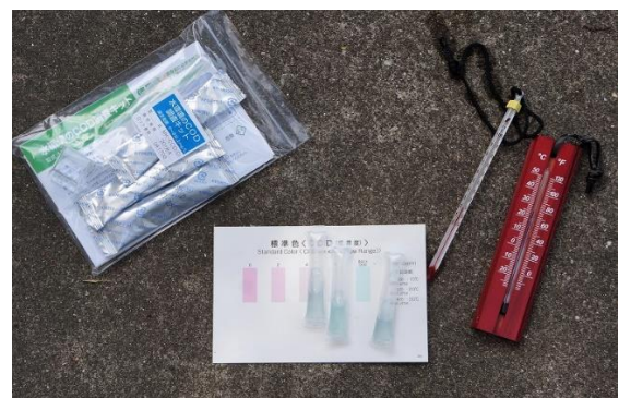
水質調査機材＝パックテスト COD・標準色・水温計・
