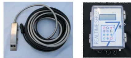
図-2 超音波式流速センサー（左） 計測通信器（右）
